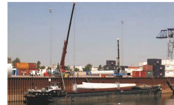
Figure 217 : Acheminement d'une pale par bateau (©ATER Environnement)
